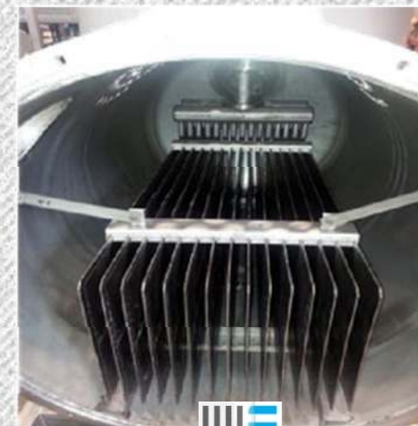
Schimbător de căldură cu plăci imersate
